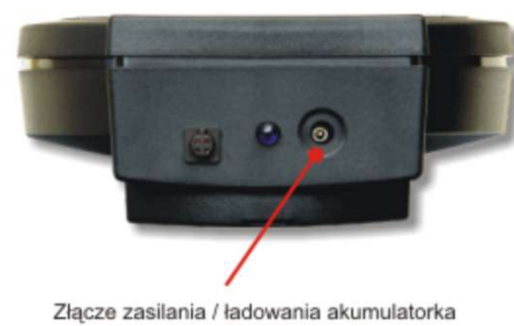
Wersja B z wbudowanym akumulatorkiem Li-Ion
