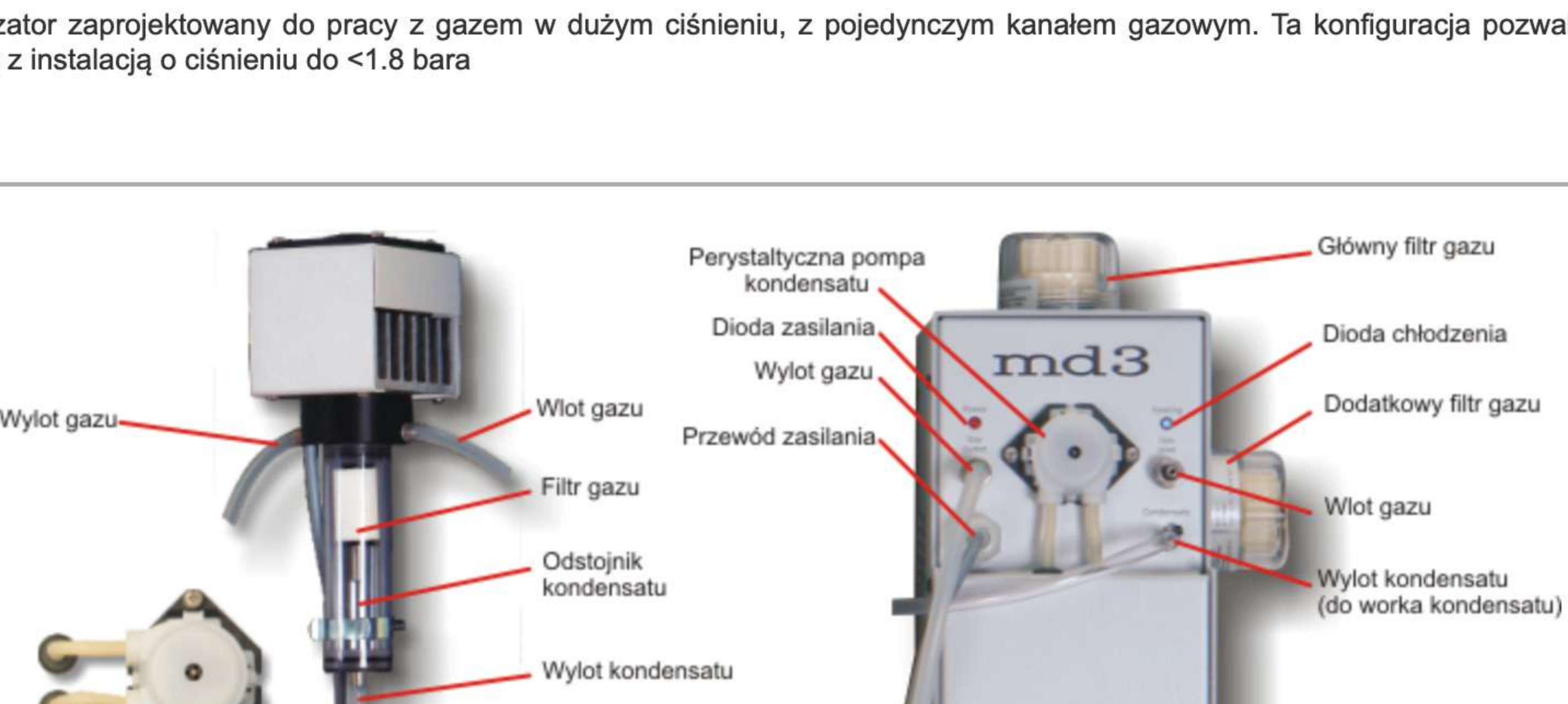
Analizator zaprojektowany do pracy z gazem w dużym ciśnieniu, z pojedynczym kanałem gazowym. Ta konfiguracja pozwala na pracę z instalacją o ciśnieniu do <1.8 bara
