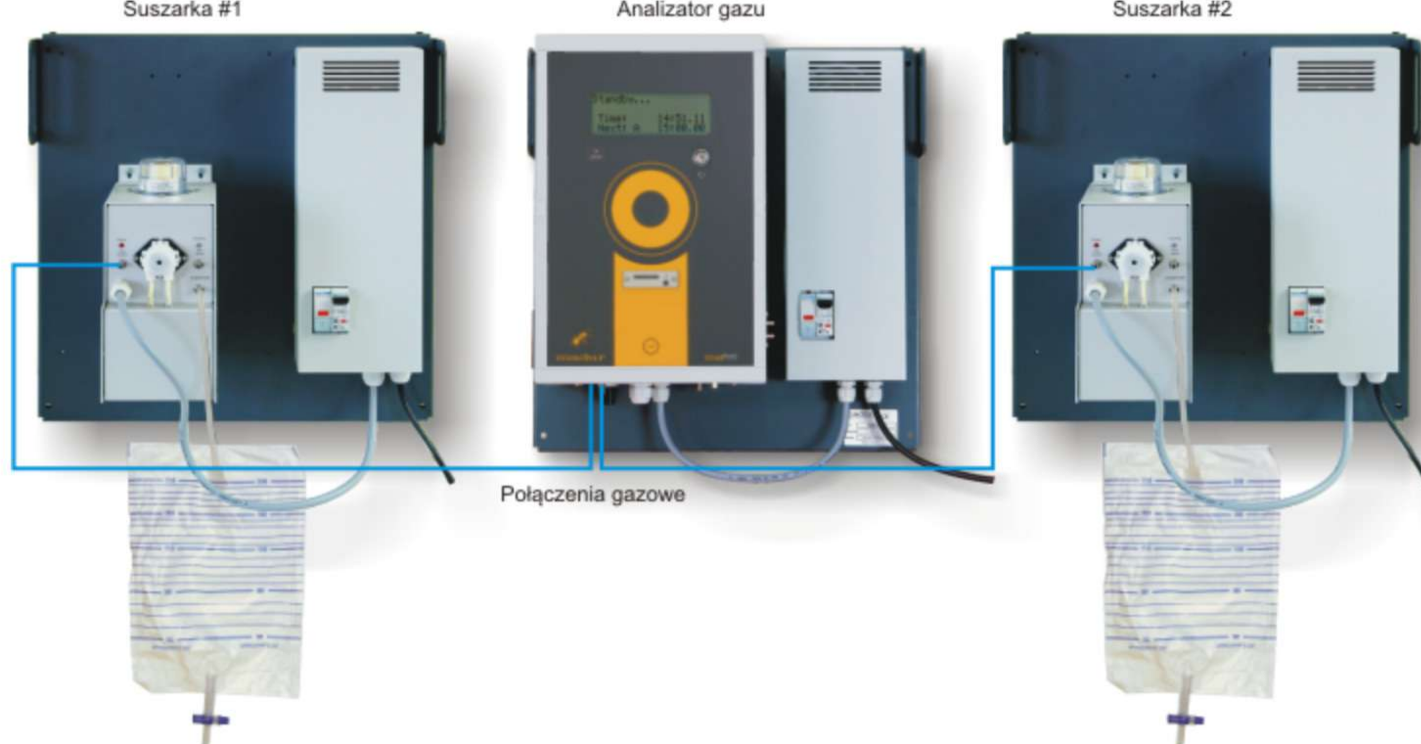
Konfiguracja Twin Split - analizator i dwie suszarki, każda na osobnej płycie, każda wyposażona we własne źródło zasilania. Pozwala to na dokonywanie pomiarów z dwóch różnych lokalizacji (każda suszarka montowana jest w pobliżu swojego miejsca pomiaru). maMoS dokonuje pomiaru turego - jeden cykl pomiarowy na lokalizację.
